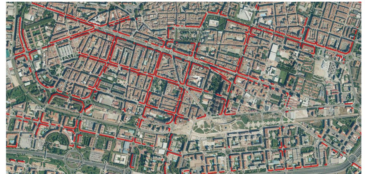
A partir de esta aproximación, se realiza una agrupación de los receptores en función de criterios de proximidad que permiten definir zonas con una componente lineal y van a indicar zonas de afección en función de los emisores.
