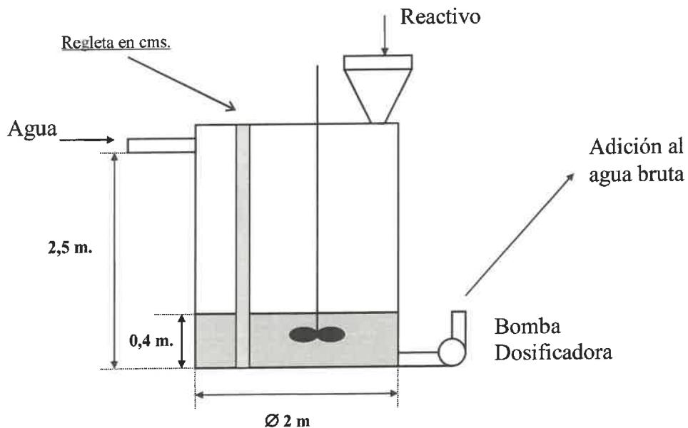
Hay un depósito de **2 metros de diámetro**, cuya **altura máxima útil es de 2,5 metros**. La preparación de reactivo se hace *in situ* adicionando el reactivo en polvo mediante la tolva situada en la parte superior y añadiendo agua hasta conseguir la concentración deseada.
