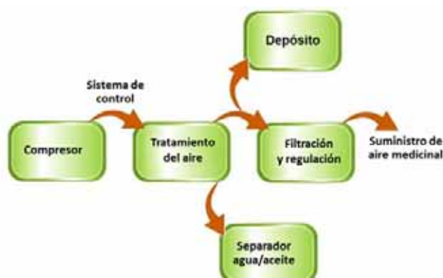
Esquema etapas del proceso central de aire comprimido
