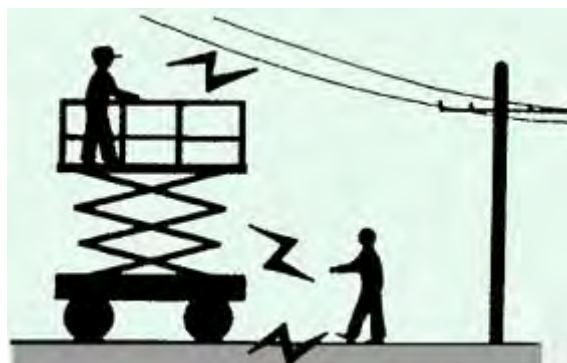
Figura 5 Contacto eléctrico directo con líneas eléctricas aéreas de AT.
