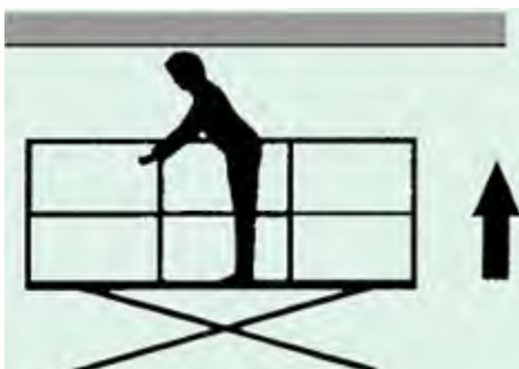
Figura 4 Choques contra objetos fijos en la fase de elevación de la plataforma
