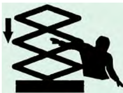
Figura 6 Atrapamiento de extremidades superiores en la estructura extensible
