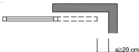
Figura 2.1 Holgura para evitar atrapamientos
