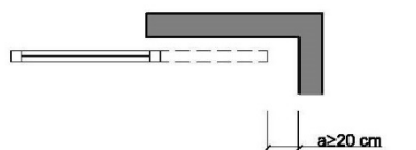
Figura 2.1 Holgura para evitar atrapamientos
