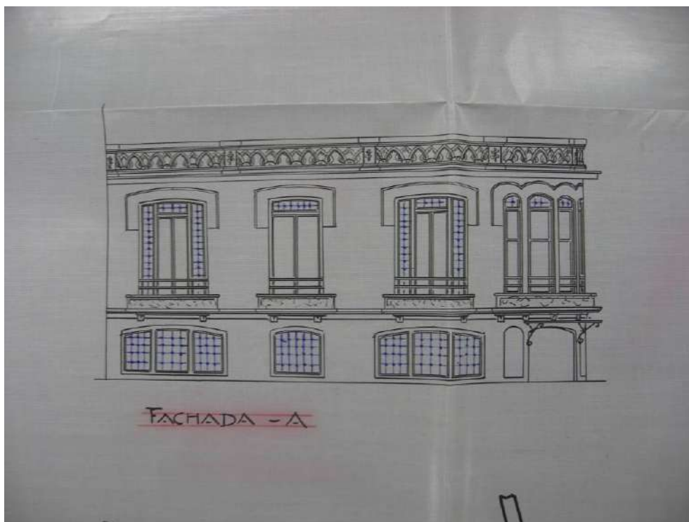
Fachada delantera a calle Vara de Rey. Se observa que los huecos son de diferentes tamaños y que no guardan ningún parecido con los actuales. Además el acceso se hace por la zona curva.
