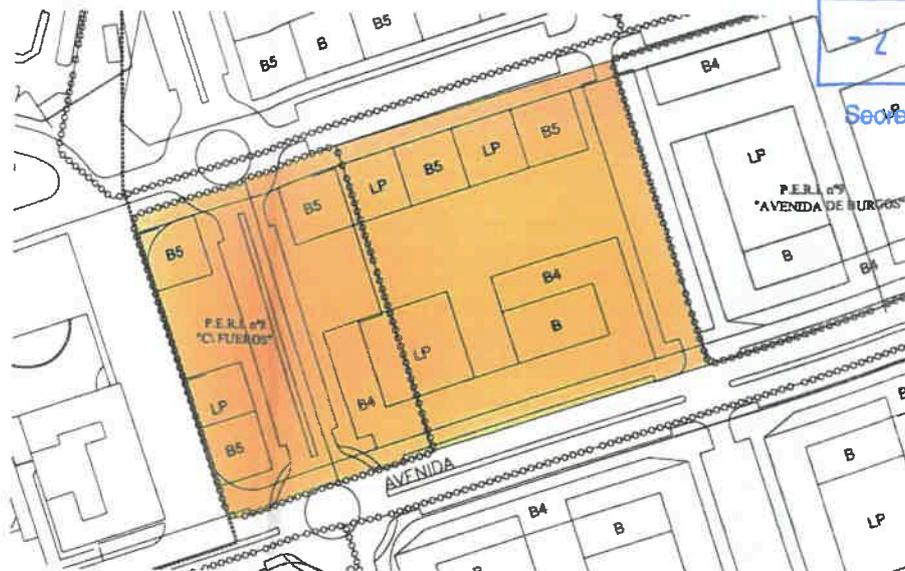
Se ha constatado, según se puede apreciar en el levantamiento topográfico aportado, un desvío del eje de comunicación transversal perpendicular a Avenida de Burgos y paralelo a la actual C/Fueros de Logroño, de prácticamente 2 metros hacia el Este, con respecto a lo previsto en la ordenación de la modificación puntual en Avd. Burgos 72 a 82 y las directrices.
